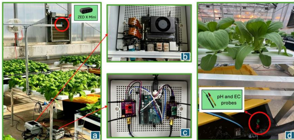
Gambar 2.2 (a) Sistem pemantauan pertumbuhan sayuran berkemampuan IoT dipasang di rumah kaca; (b) Tugas pengendalian sistem dan pemrosesan data dilakukan menggunakan papan NVIDIA Jetson; (c) Sensor pH dan EC dihubungkan dengan papan mikrokontroler Arduino Nano untuk data perolehan; (d) Sensor pH dan sensor EC direndam dalam tangki penampung nutrisi untuk melacak perubahan dalam larutan nutrisi (Kang, et al. , 2024).
