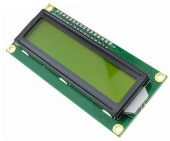
Gambar 2.11 Tampilan fisik modul LCD 2x16.
