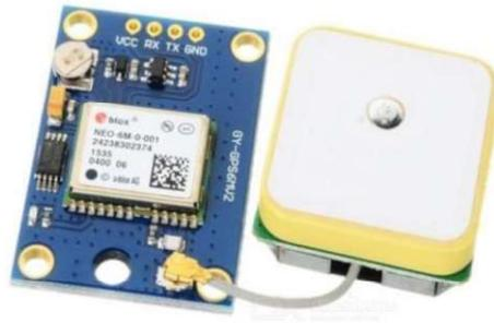
Gambar 2. 3 Modul GPS U-blox Neo-6m V2
