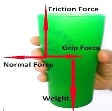
Gambar 16. Diagram benda bebas objek (Lai, 2016).
