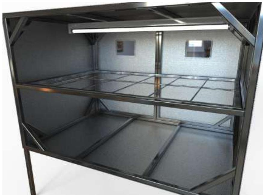
Gambar 3.4 Desain 3D tampak belakang alat pengering pengecatan *body* sepeda motor dengan sistem pemanas *glass heater*
