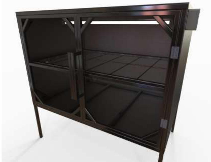
Gambar 3.3 Desain 3D tampak depan alat pengering pengecatan *body* sepeda motor dengan sistem pemanas *glass heater*
