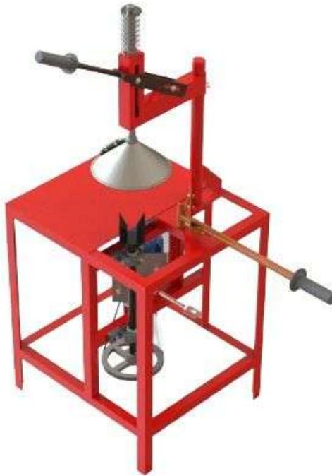
Gambar 3.3 Desain 3D alat pengupas kelapa muda dengan sistem penggerak motor listrik
