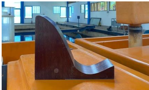
Gambar 17. Model bendung dan kolam olak tipe bak tenggelam.
