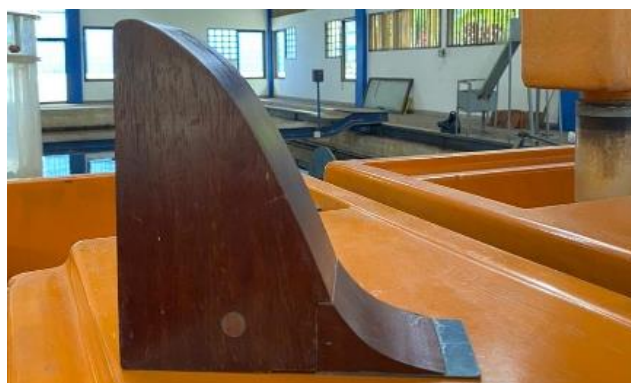
Gambar 15. Model bendung dan kolam olak tipe vluhter panjang 5,7 cm.
