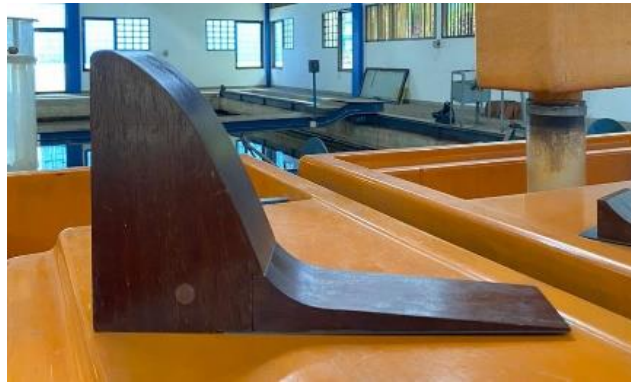
Gambar 16. Model bendung dan kolam olak tipe vluhter panjang 19 cm.
