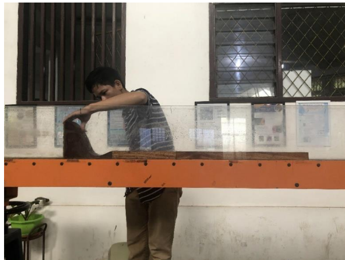
Gambar 26. Pemasangan model penelitian tipe bak tenggelam.
