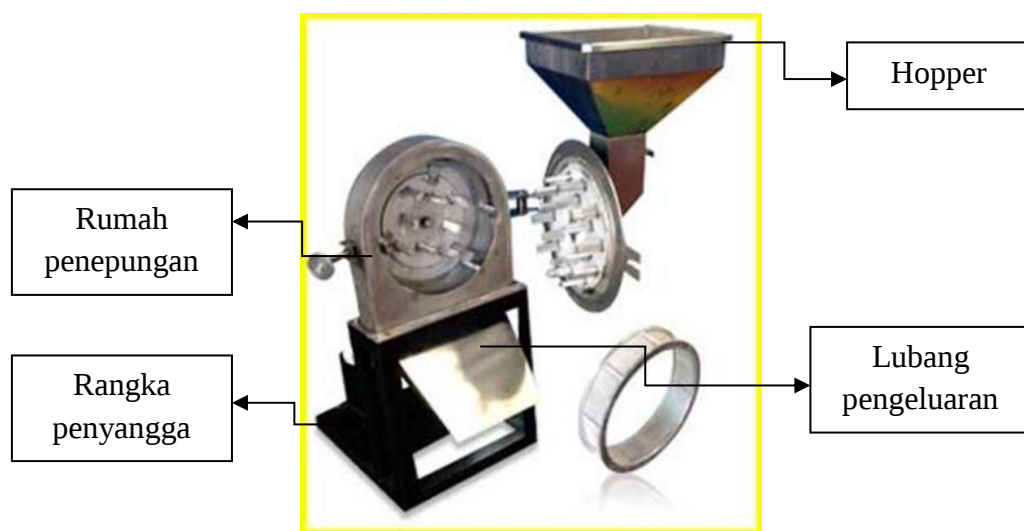
Gambar 7. Komponen penyusun disc mill Sumber: Efendi dan Suhartono (2019)
