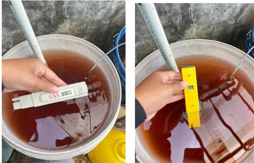
Gambar 10. Pengukuran pH, dan pengukuran ppm.
