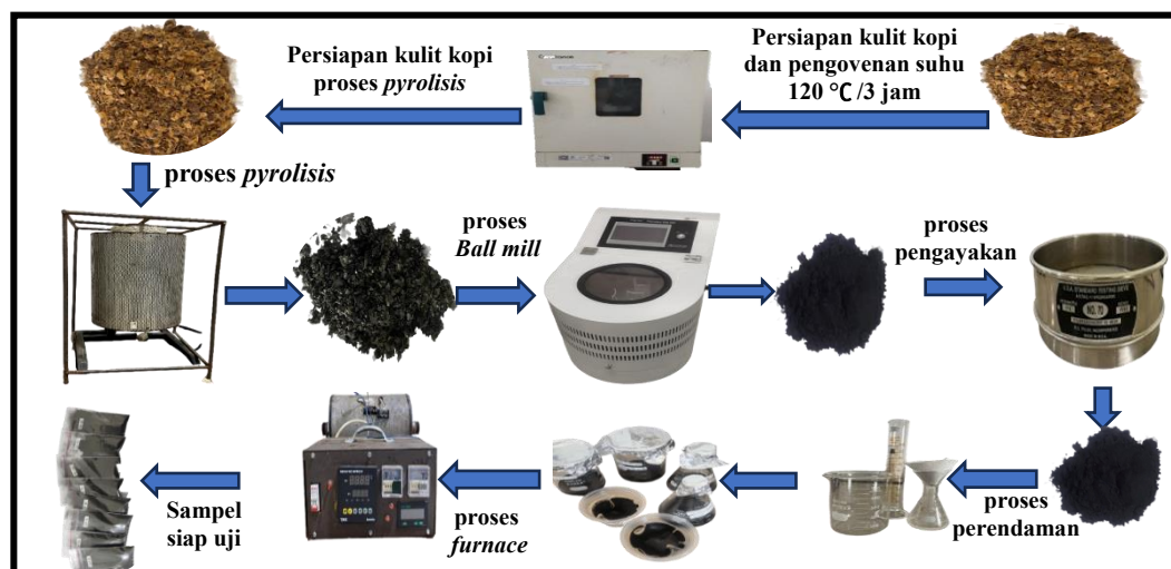
Gambar 3.8 Desain prosedur pembuatan karbon aktif.
