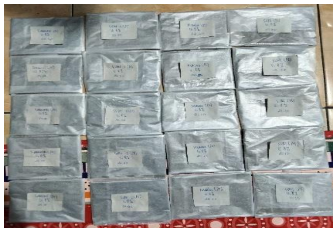
Gambar 6. Pengusangan dengan melembabkan benih sorgum pada kertas buram lembab dalam larutan etanol selama 12 jam.
