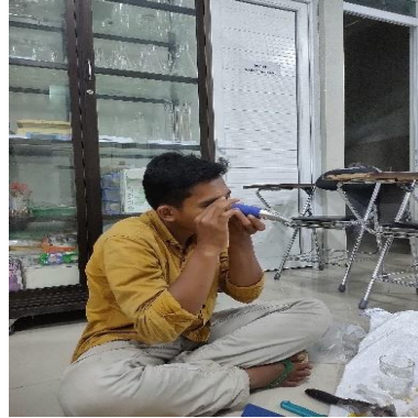
Gambar 26. Pengamatan kandungan brix menggunakan refraktometer.
