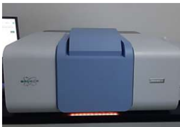
Gambar 2.8 Alat karakterisasi FTIR (Jhonston, 1990).
