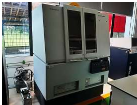
Gambar 2.6 Alat karakterisasi XRD (Bragg & Bragg, 1913).
