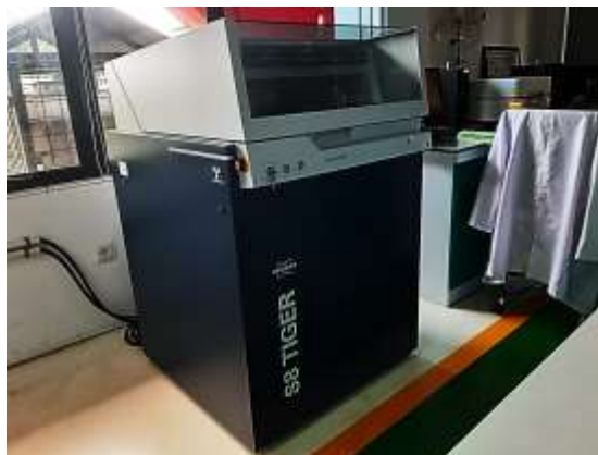
Gambar 2.5 Alat karakterisasi XRF (Barkla, 1918).
