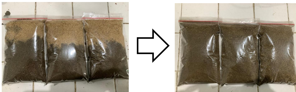
Gambar 5. Pencampuran Sampah Daun dan Serbuk Gergaji
