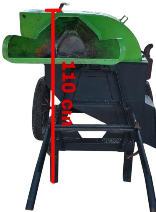
Gambar 3 Tinggi Mesin Perajang Biomassa Tipe Slicer 110 cm
