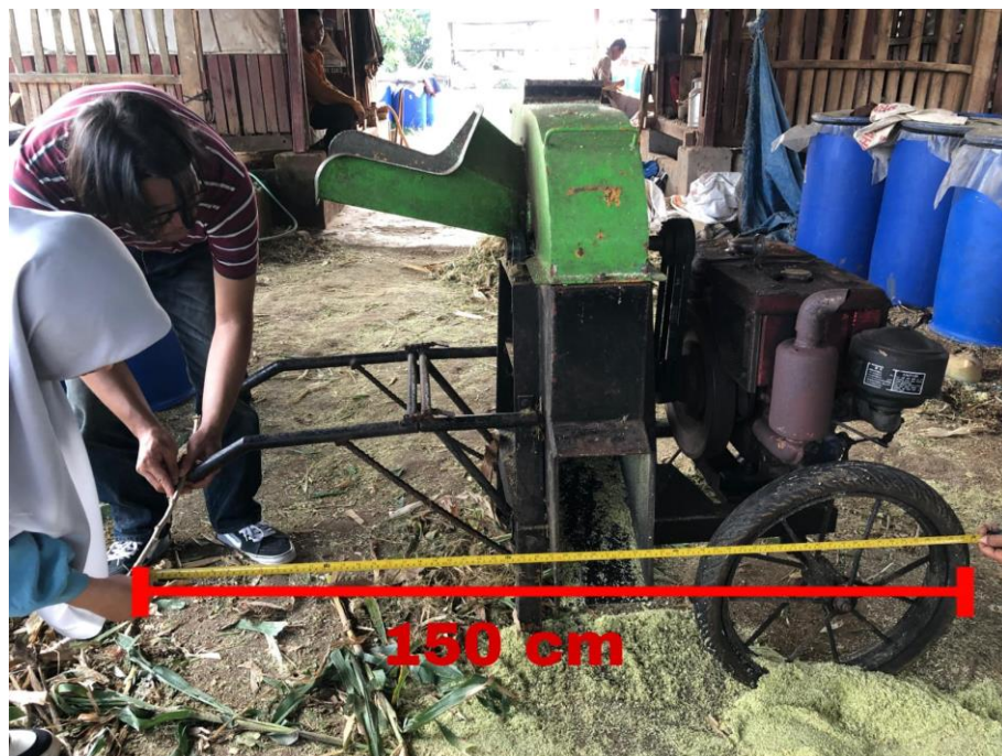
Gambar 4 Panjang Mesin Perajang Biomassa Tipe Slicer 150 cm
