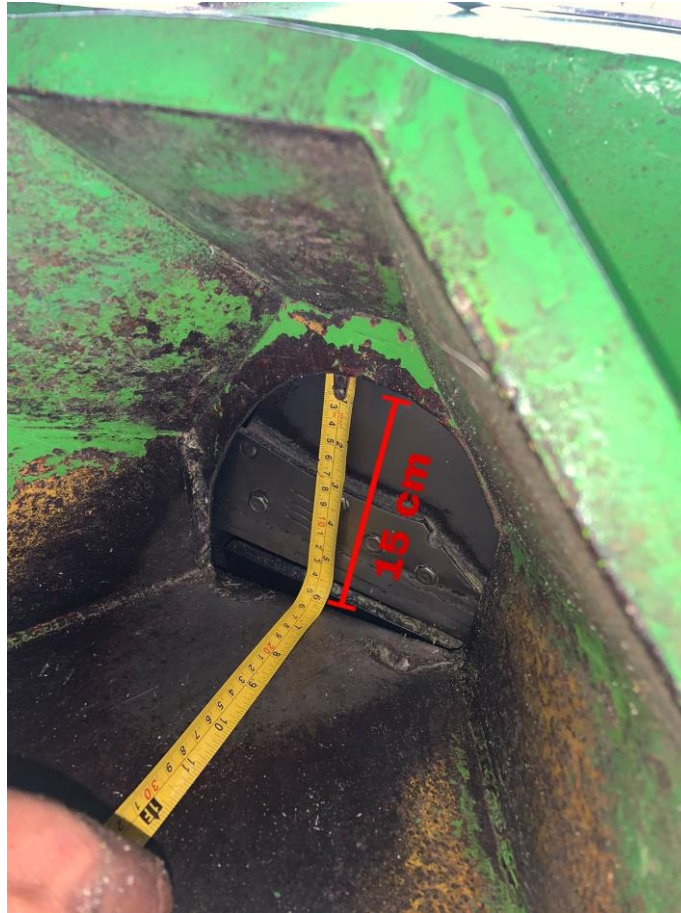
Gambar 7 Tinggi Hopper Dalam 15 cm
