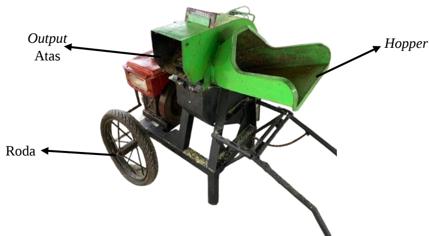
Gambar 4. Alat Perajang Biomassa Tipe Slicer
