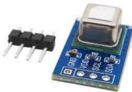
Gambar 5. Detektor Gas CO 2 sensor SCD41[23]
