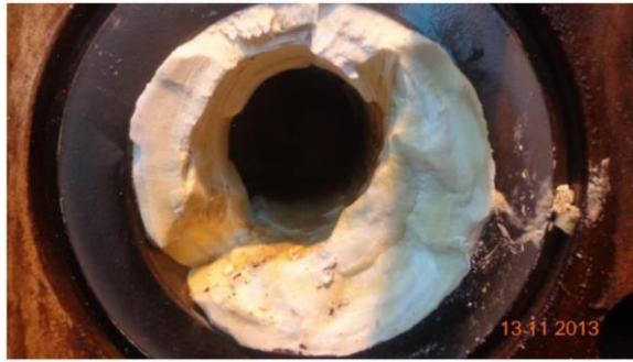
Gambar 1. Pembentukan kerak pada pipa produksi minyak dan gas (Wilastari dkk., 2021).
