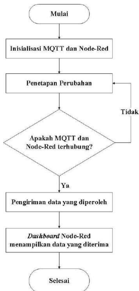
Gambar 3.5 Diagram Alir Perancangan IoT
