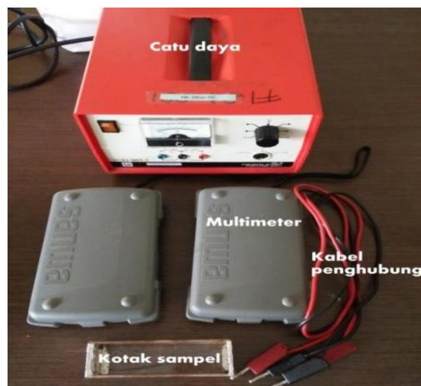
Gambar 2.1 Alat Pengukuran tahanan jenis (Sari et al. , 2019)
