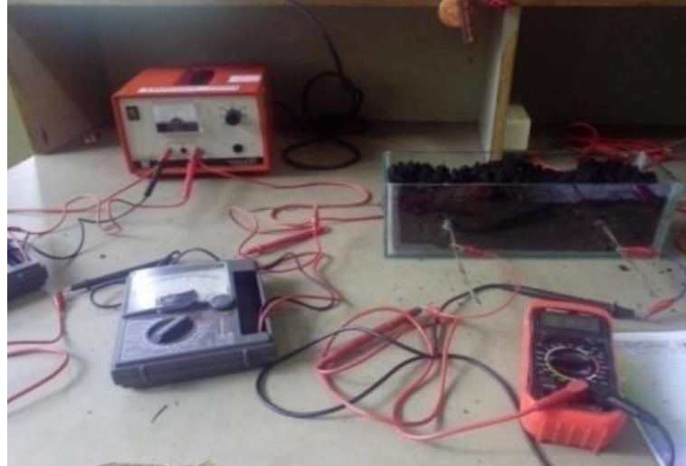
Gambar 2.3 Soil box dan rangkaian alat (Septiyani dan Ivansyah, 2016)
