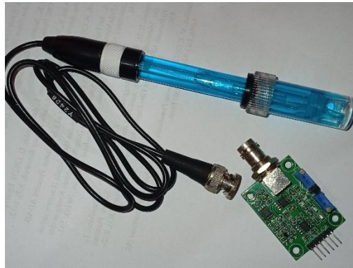
Gambar 2.15 Sensor pH 4502C (Dokumentasi Pribadi)
