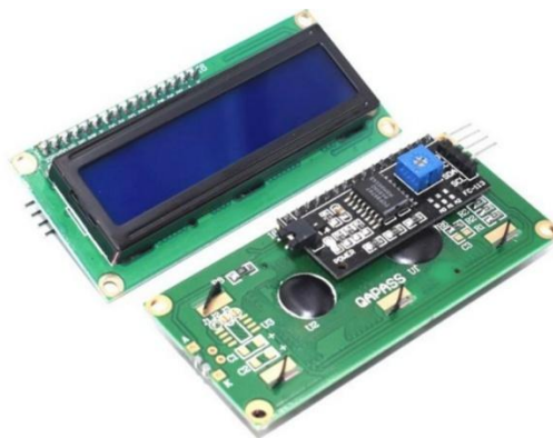
Gambar 2.22 Pin pada LCD 16×2 ( Datasheet I2C 16×2 LCD, 2021 )
