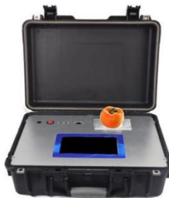
Gambar 6. Pembangunan alat deteksi kualitas spektrum infrared dekat Portable (Su et al. , 2020).
