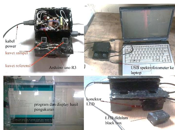
Gambar 1. Pembuatan spektrofotometer sederhana (Yohan, 2018).
