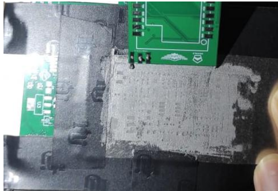
Gambar 3.18 Proses aplikasi timah pasta dengan stencil
