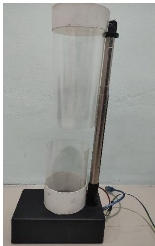
Gambar 8. Rangkaian Alat Praktikum Gerak Jatuh Bebas.
