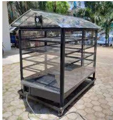
Gambar 2. Alat pengering hybrid tipe rak (Warji dkk., 2023)
