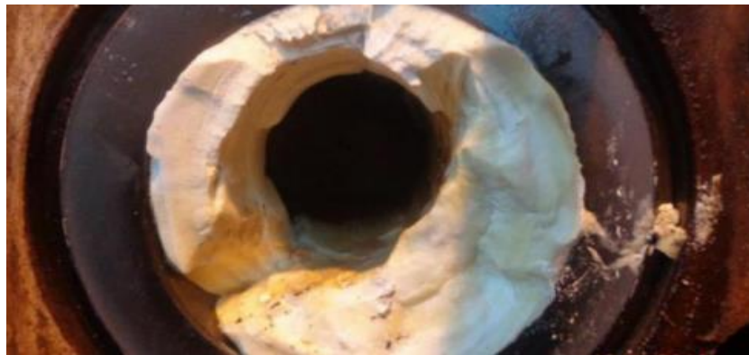
Gambar 1. Pembentukan kerak pada pipa (Marais et al. , 2016)
