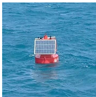
Gambar 2. 1 Perangkat Buoy U-TEWS
