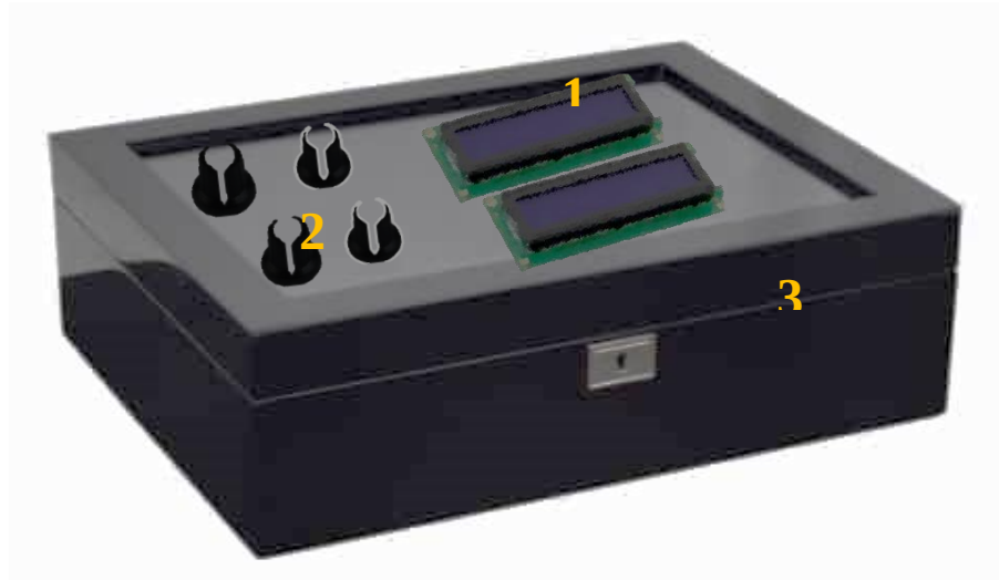
Gambar 2. Desain Model Alat prediksi kadar unsur hara dalam tanah.
