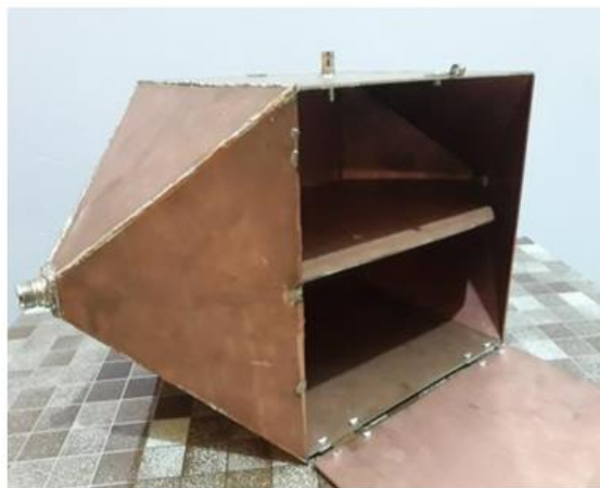
Gambar 2. 6 Tem-Cell Tipe Tertutup[13]
