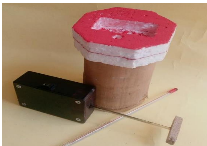
Gambar 1. Rangkaian alat kalorimeter bambu yang dibuat oleh Farida, dkk.
