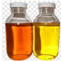
Gambar 3.7 Penyediaan sampel minyak isolasi untuk memperbanyak variasi pengukuran
