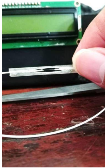
Gambar 3. 10 Perancangan serat optik (core) yang dijepit dengan papan akrilik
