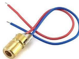
Gambar 3.5 Laser diode digunakan untuk sebagai sumber cahaya menuju fiber optik
