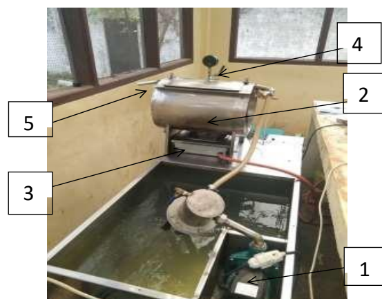
Gambar 2. Mesin Vacuum Fryer dan bagian–bagian
