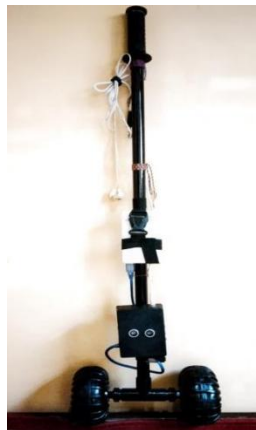
Gambar 2.12 Alat Bantu Navigasi Tunanetra berbasis Arduino
