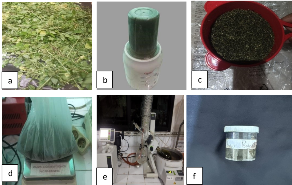
Gambar 8. Proses pembuatan ekstrak daun babandotan: (a) Pemisahan daun babandotan untuk dikering anginkan, (b) Penghalusan daun babandotan, (c) Penyaringan serbuk (d) Penimbangan serbuk daun babandotan, (e) Penguapan pelarut dengan rotary evaporator, dan (f) Ekstrak babandotan.
