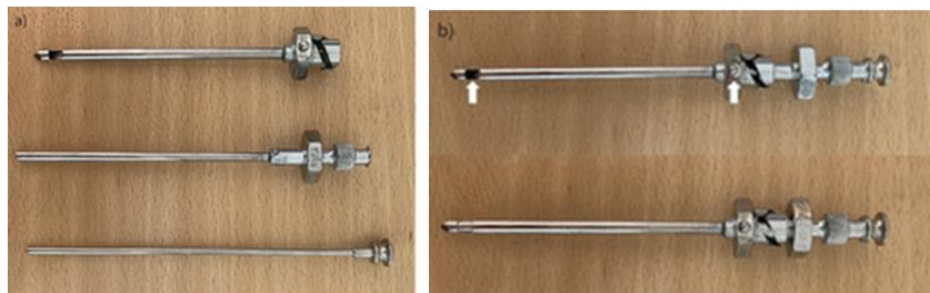
Gambar 11. a. Jarum abrams terdiri dari 3 bagian dari atas ke bawah silinder luar, silinder dalam dengan ujung pemotong dan stilet. b. jarum Abrams yang telah dirakit dalam posisi terbuka dengan indicator takik pada pegangan sejajar dengan takik spesimen yang terbuka (panah), dibawahnya adalah jarum dalam posisi tertutup karena silinder dalam telah diputar kebawah ke dalam silinder luar.
