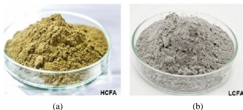
Gambar 2.2 Jenis-jenis fly ash : (a) high-calcium dan (b) low-calcium (Chindaprasirt dan Rattanasak, 2023).
