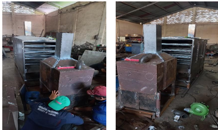
Gambar 3.6 Proses pembuatan dan penggabungan elemen heater dan tungku
