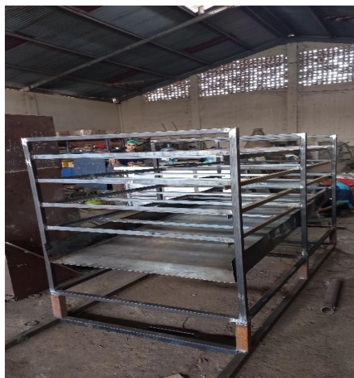
Gambar 3.2 Proses pembuatan rangka bed dryer .
