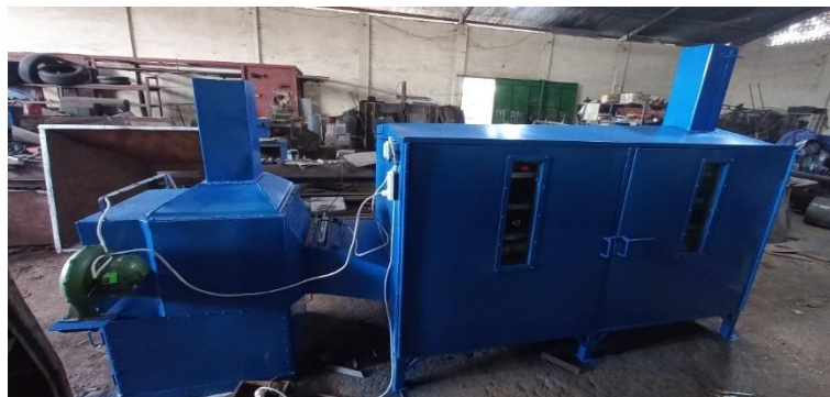
Gambar 3.7 Pengering hybrid tipe bed dryer heater dan tungku pembakaran kayu biomasa
