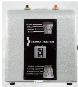
Gambar 3.16 Alat kadar air CERRA TESTER
