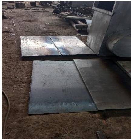
Gambar 3.3 Pembuatan dinding pengering dari pelat 2.5 mm
