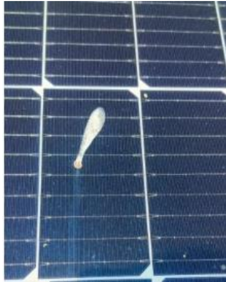
Gambar 4. Contoh Hot Spot Pada Modul Surya (Rosyid et al., 2025)
