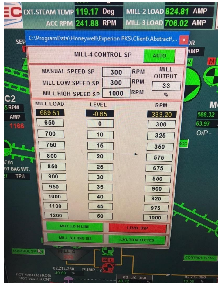
Gambar 3.4. Logika kecepatan giling yang di atur oleh operator mill DCS
