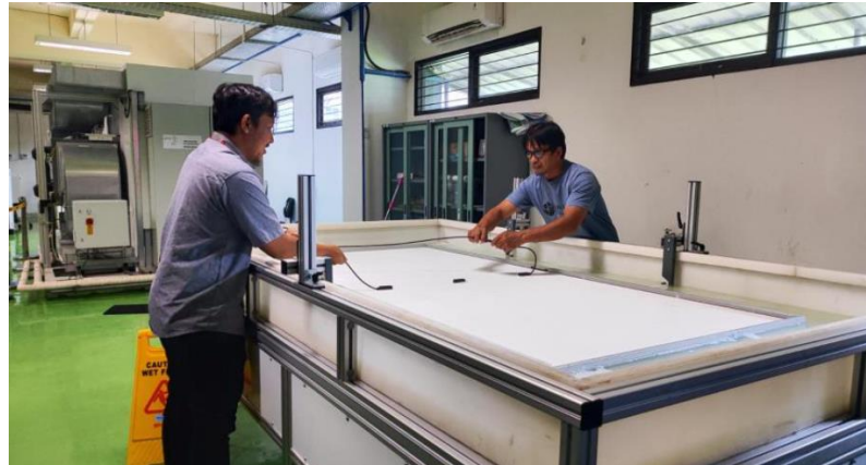
Gambar 3.4 Proses Pengujian Arus Bocor (MQT 15) (Sumber : Laboratorium Fotovoltaik, BRIN)
