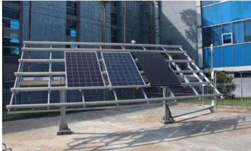
Gambar 3.5 String Terbuka pada Pengujian Outdoor (Sumber : BRIN, 2024)
