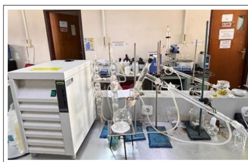
Gambar 2.7 Alat Destilasi Sederhana
