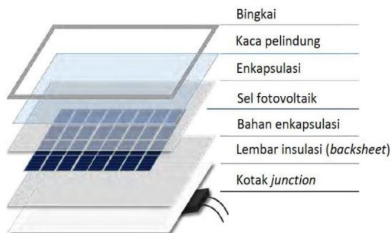
Gambar 2.4 Struktur Modul Photovoltaic
