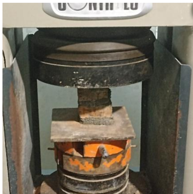
Gambar 3.6 Pengujian kuat tekan.
