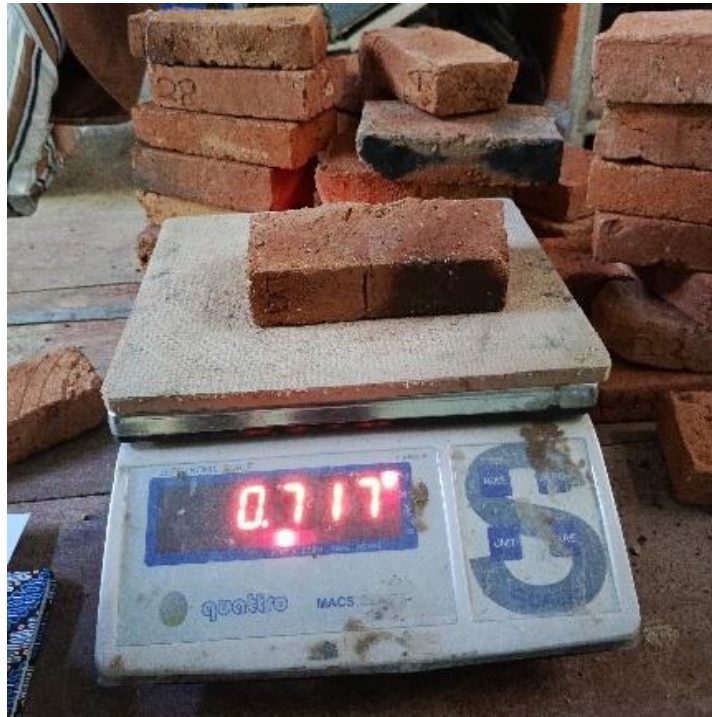
Gambar 3.7 Pengujian daya serap air.
