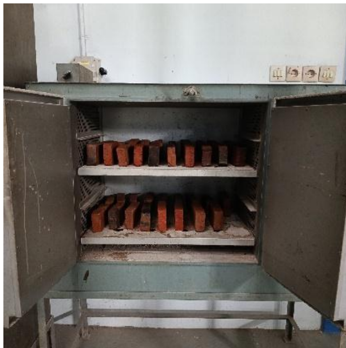
Gambar 3.8 Pengujian kerapatan semu.
