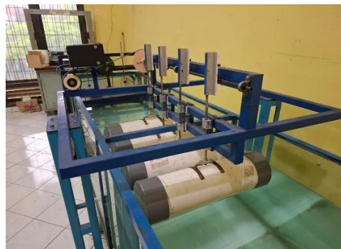
Gambar 1.2 PLTGL Point Absorber
