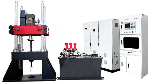
Gambar 3 Alat Uji Fatik Aksial Sumber: (Adam & N S Dera, 2021)
