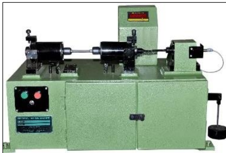
Gambar 5 Alat Uji Fatik Kombinasi Sumber: (Amiruddin & Lubis, 2018)
