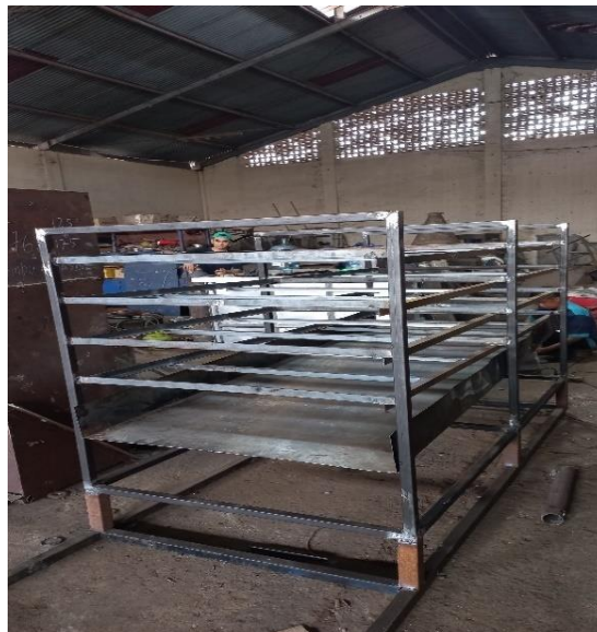
Gambar 3.3 Proses Pembuatan Rangka Bed Dryer
