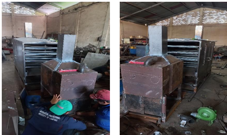
Gambar 3.7 Proses Pembuatan dan Penggabungan Elemen Pemanas Heater dan Tungku
