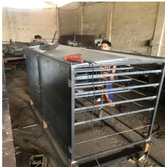
Gambar 3.5 Proses Penempelan Dinding Pengering ke Rangka
