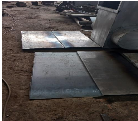
Gambar 3.4 Pembuatan Dinding Pengering dari Plat 1.2 mm
