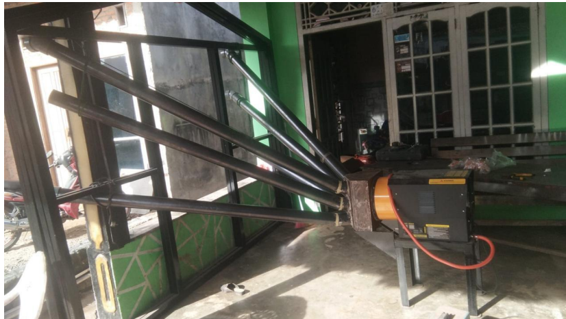
Gambar 3.16 Pembuatan Rangka Mesin Pengering
