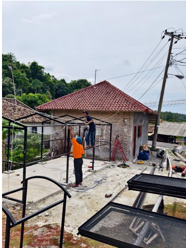
Gambar 3.18 Perakitan Rangka Mesin Pengering
