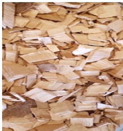
Gambar 2.5 Bahan bakar biomassa berupa woodchip hasil dari cacahan kayu.
