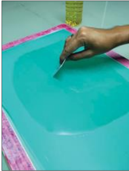
Gambar 6. Pemberian Minyak Pada Permukaan Screen . Sumber: Pengantar Cetak Sablon, 2022.
