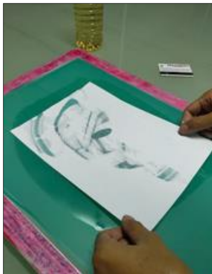
Gambar 7. Peletakan film Desain Pada Screen . Sumber: Pengantar Cetak Sablon, 2022.
