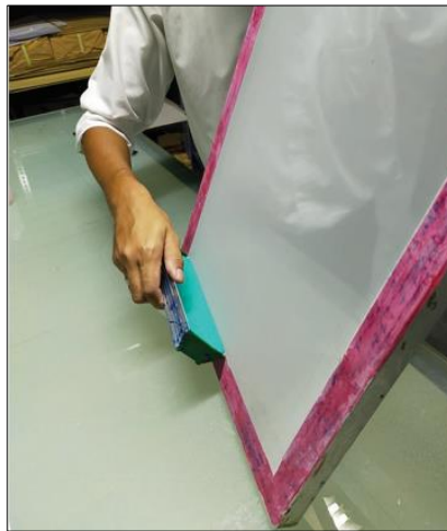
Gambar 3. Pengolesan Afdruk Pada Screen . Sumber: Pengantar Cetak Sablon,2022.
