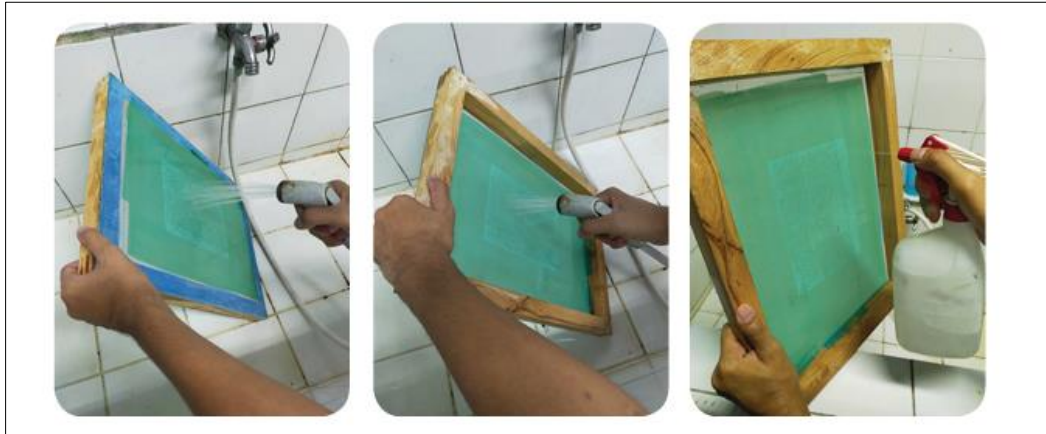
Gambar 10. Pembersihan Sisa Minyak dan Penyemprotan pola Gambar. Sumber: Pengantar Cetak Sablon, 2022.
