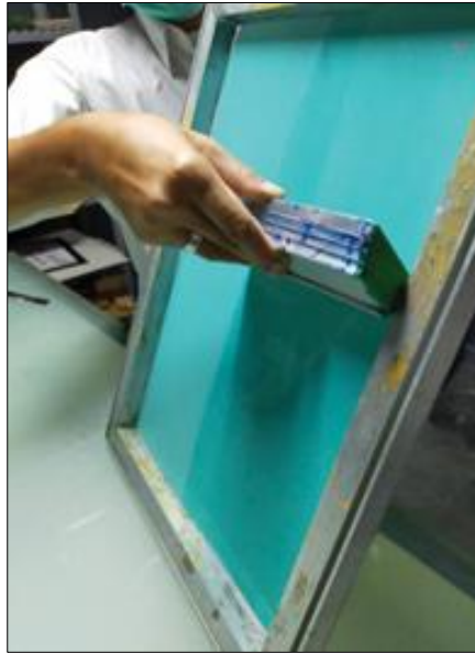
Gambar 4. Pengolesan Afdruk Hingga Rata. Sumber: Pengantar Cetak Sablon,2022.
