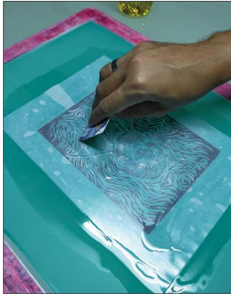
Gambar 8. Penghilangan Gelembung Udara Antara Desain Film dan Screen . Sumber: Pengantar Cetak Sablon, 2022.
