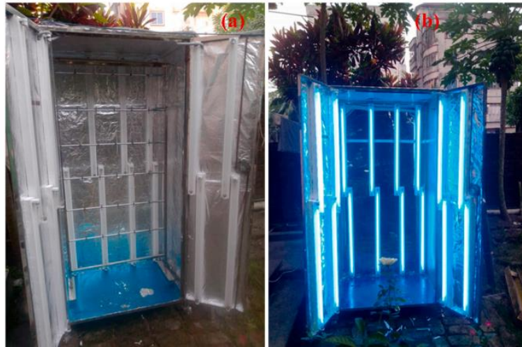
Gambar 2.1 Prototipe ruang desinfeksi UV-C. Tampilan (a) tanpa pencahayaan dan (b) setelah pencahayaan (Mohsin et al. , 2024).
